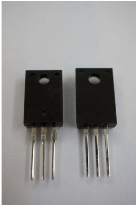
圖三、AT 模具(左)與 HG 模具(右整體)背面外觀比較
